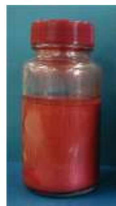
アクリル樹脂 レッドマイカ沈降試験 1%添加 1年経過
